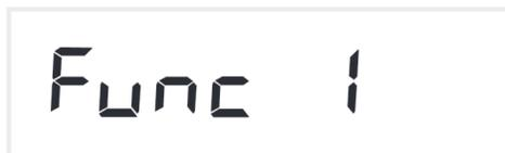
Dieser wird durch die Info-Anzeige „Func“ (function) angezeigt. In diesem Menü-Punkt wird die Funktion des Gerätes eingestellt. Der Wert kann mit den Tasten „▲▼“ geändert werden. Die Einstellung wird mit der Taste „**SET**“ bestätigt und das Gerät wechselt zum nächsten Menü-Punkt.
